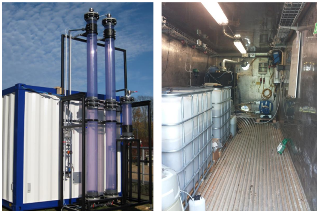
Figur 4.2. Ozonerings- och denitrifikationspilot vid Nykvarnsverket.
