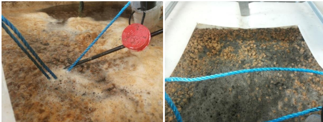
Figur 5.22. Skumbildning och svart slam i pilot EDN.
