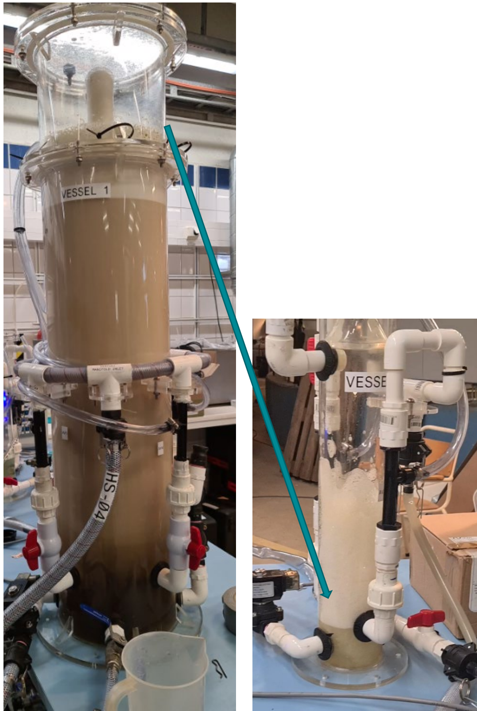
Figur 3-11. Skumfraktionering med bänkskaleutrustning från Envytech /OPEC Systems: vänster – primär fraktionering; höger – sekundär fraktionering av avskilt koncentrat från primär fraktionering.
