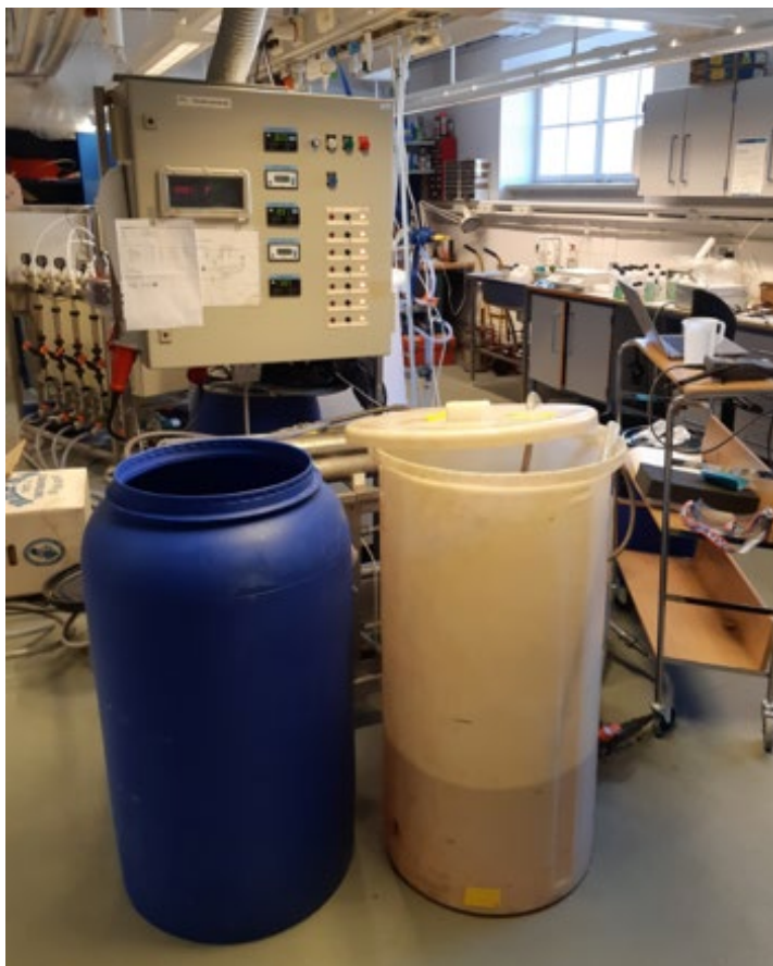
Figur 3-8. Nanofiltreringsanläggning med tankar med permeat och retentat.
