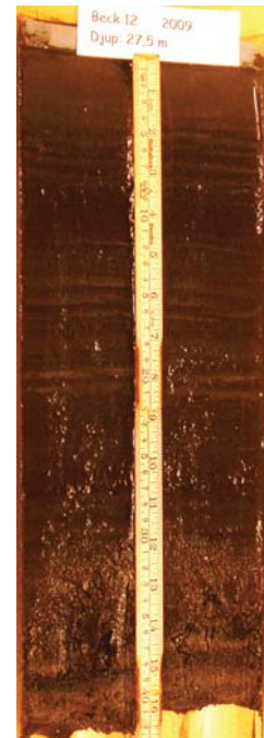
Figur 21 Typisk sedimentkärna (Beck 12) från Saltsjön sydväst Manillaskolan, djup 27,5 m. Oxiderat ytskikt på några cm överlagrande mörkt reducerat sediment. Notera djurgångarna i ytskiktet. Till höger redovisas samma kärna i snittat skick.
