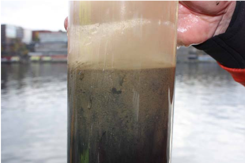
Figur 21 Typisk sedimentkärna (Beck 12) från Saltsjön sydväst Manillaskolan, djup 27,5 m. Oxiderat ytskikt på några cm överlagrande mörkt reducerat sediment. Notera djurgångarna i ytskiktet. Till höger redovisas samma kärna i snittat skick.
