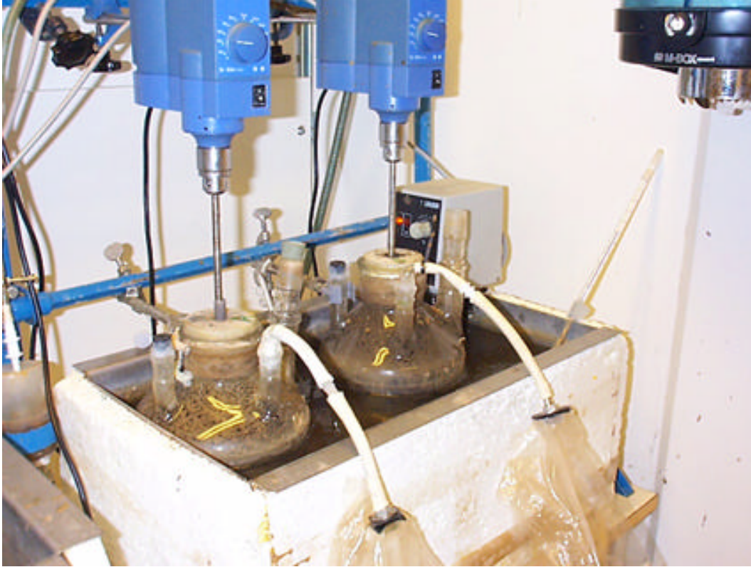
Figur 3. Utrustning för satsvisa utrötningsförsök.
